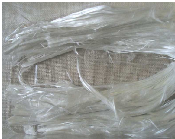
Rys. Włókna azbestu
