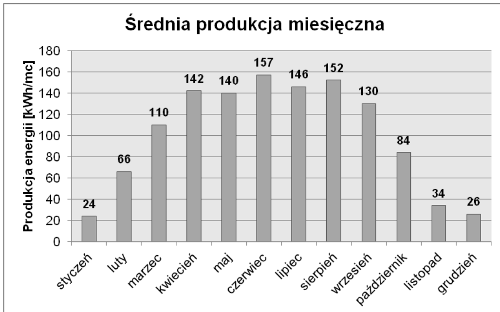
Wykres 10. Produkcja energii elektrycznej przez panele fotowoltaiczne
